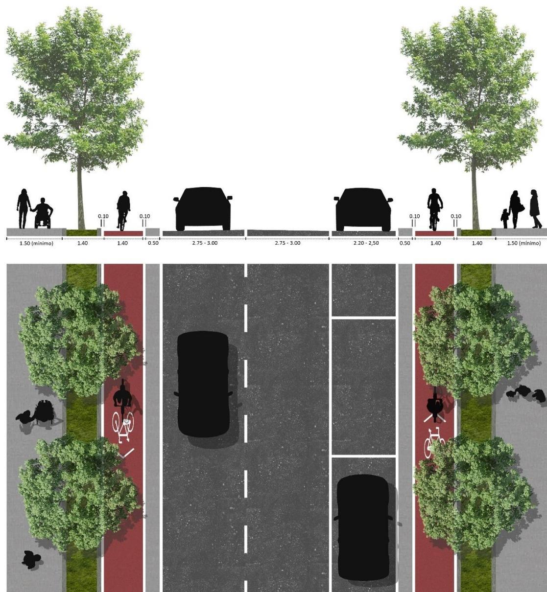
Figura 26. Perfil-tipo de pista ciclável unidirecional com estacionamento em paralelo
