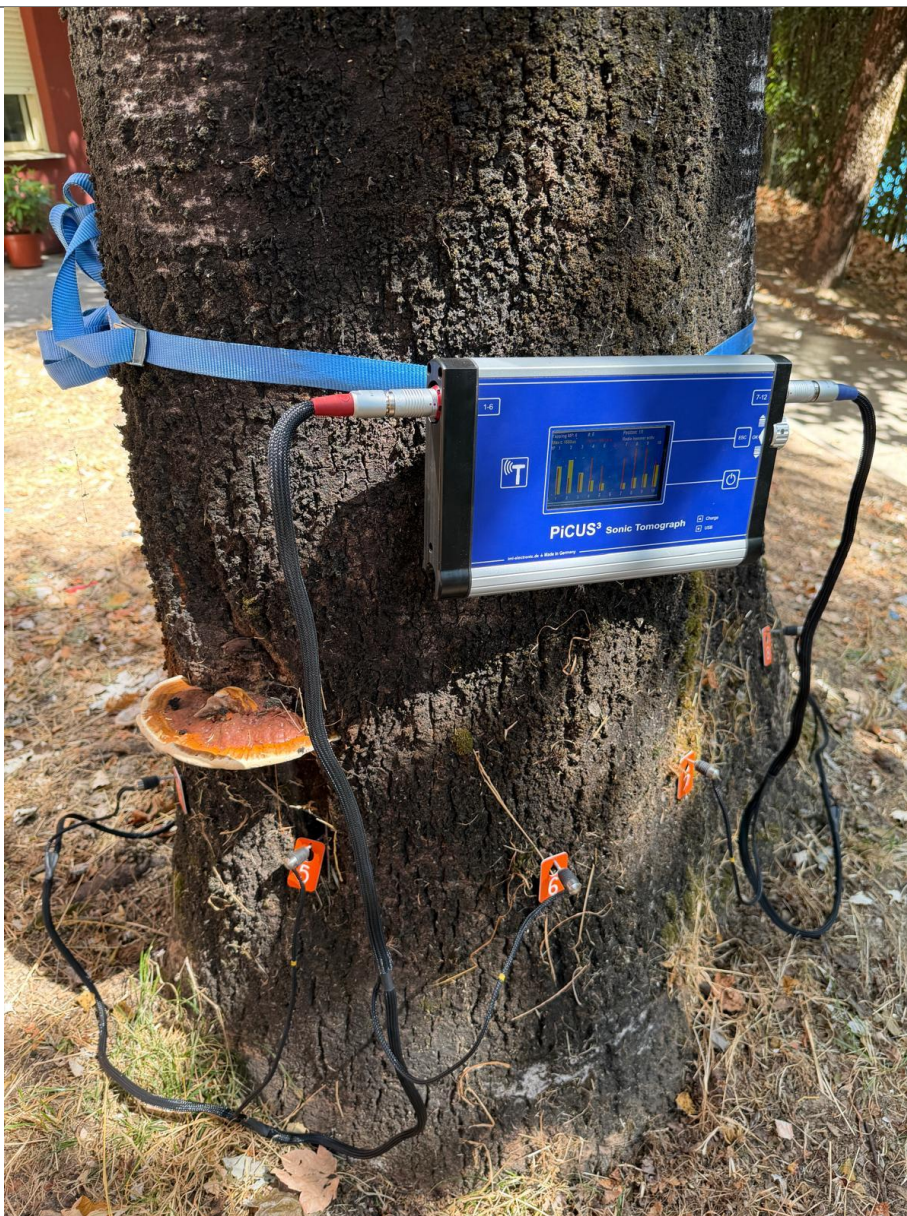
Figura 3: Corpo frutífero de fungo patogénico ( Ganoderma resinaceum ); plano de análise do tomógrafo sónico
